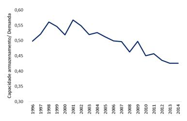
Figura 2 – Relação entre a capacidade de armazenamento do SIN e a demanda, 1996-2014 (ONS, 2016 e EPE, 2014)
